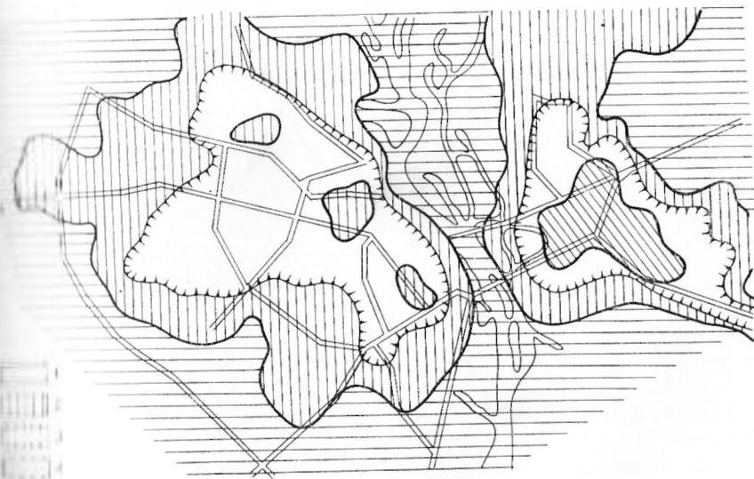
Рис. 54. Карта-схема разностей температуры воздуха ( ^{\circ}\text{C} ) между данными города и окрестностей. Лето. 1) 0^{\circ}\text{C} и ниже; 2) 0,1 - 0,5^{\circ}\text{C} ; 3) 0,6 - 1,0^{\circ}\text{C} ; 4) 1,1 - 1,5^{\circ}\text{C} .
